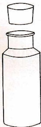
Abb. 54. Metallbecher zur Zuckerbestimmung nach A. Herzfeld.
