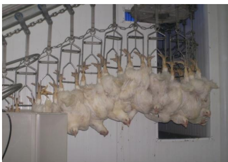
Figura 2. 4 Agățarea păsărilor pe conveier Figure 2.4 Hanging birds on the conveyor
