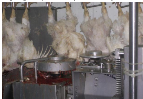
Figura 2. 6 Dispozitiv automat pentru sângereare Figure 2.6 Automatic bleeding device
