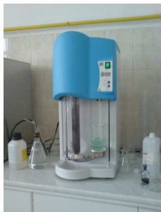
Figura 4. 6 Aprecierea cantității de proteine totale din mușchii studiați, prin aplicarea metodei Kjeldahl la sistemul VelpScientifica DK6+UDK127
