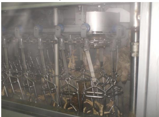
Figura 2. 9 Instalația de opărire a păsărilor
