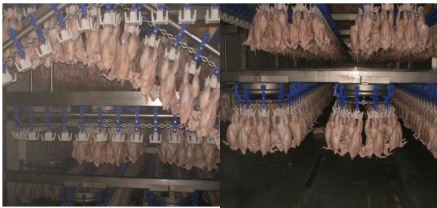
Figura 2. 14 Tunel de refrigerare a carcaselor
