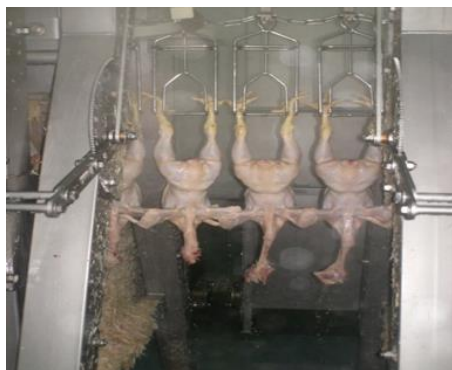
Figura 2. 10 Instalație pentru deplumarea păsărilor Figure 2.10 Installation for plucking poultry
