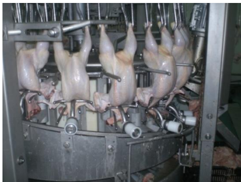
Figura 2. 12 Instalația pentru detașarea gâturilor Figure 2.12 Neck detachment installation
