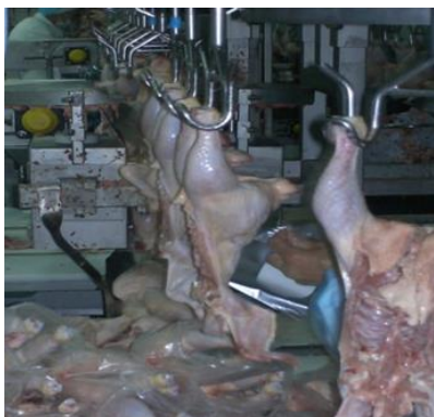
Figura 2. 16 Instalație pentru tranșarea carcaselor Figure 2.16 Installation for cutting carcasses
