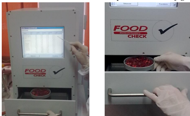
Figura 4. 4 Aprecierea cantității de proteine, collagen, lipide și apă la Analizorul Food – Check
