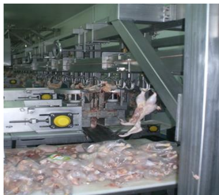
Figura 2. 16 Instalație pentru tranșarea carcaselor Figure 2.16 Installation for cutting carcasses
