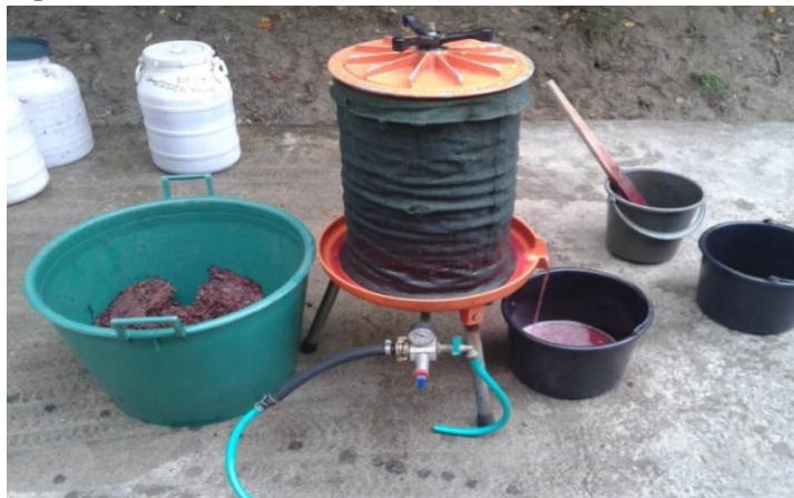
Figura nr. 3.10. Presă hidraulică cu burdof din cauciuc folosită în microvinificație (original) Figure no. 3.10. Hydraulic press with rubber bag used in micro-winemaking (original)
