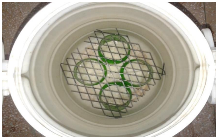
Figura nr. 3.8. Recipient din plastic cu grilaj pentru realizarea macerației carbonice (original) Figure no.3.8. Plastic container with grid for carbonic maceration (original)
