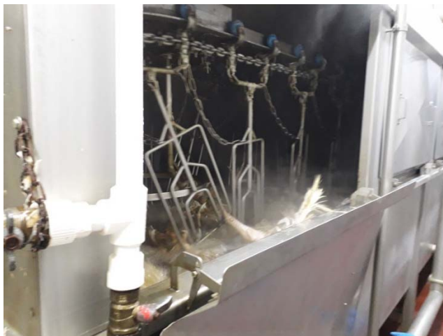
Figura 6.6 Operația de opărire a curcanilor Figure 6.6 Turkey scalding operation
