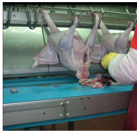
Figura 6.11 Operația de eviscerare Figure 6.11 Evisceration operation
