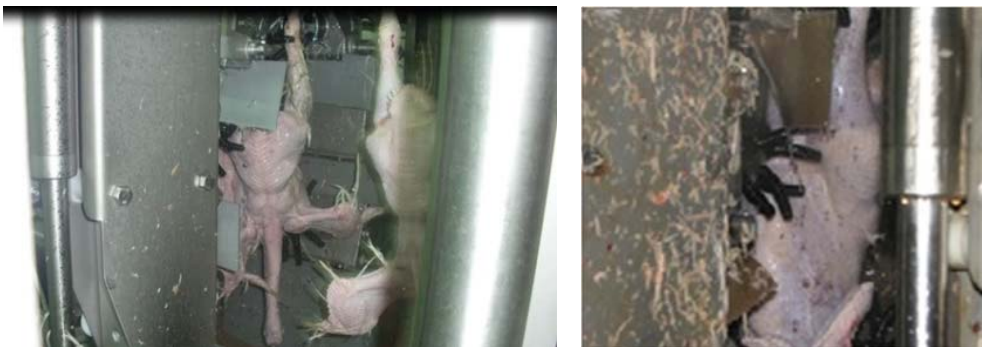
Figura 6.9 Operația de deplumare Figure 6.9 Plucking operation
