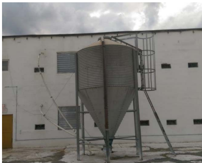
Figura 5.6 Siloz de alimentare a halelor cu furaj
