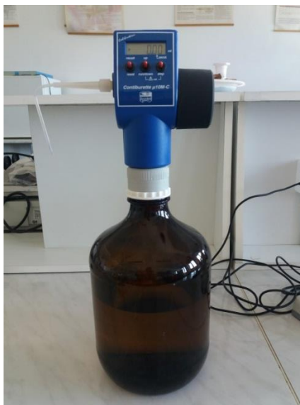
Figura 4.10. Biuretă pentru determinarea acidității (original) Figure 4.10. Burette for acidity determination
