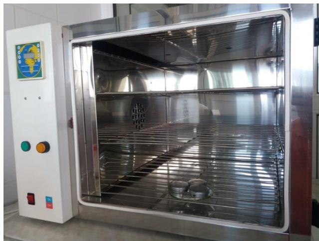
Figura 4.9 Etuvă termoreglabilă (original)
