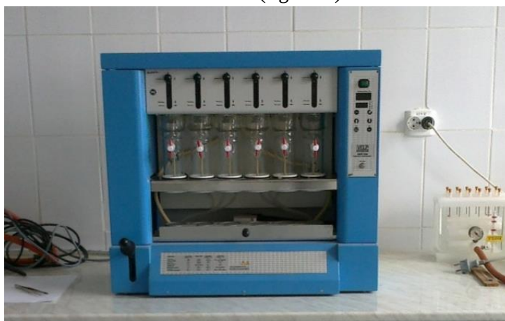
Figura 4.14 Determinarea grăsimii brute (original)
