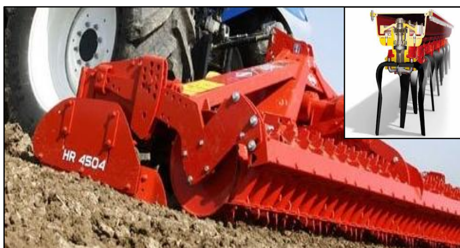
Fig. 4.6 - Freză cu rotori verticali FRV- HR 4504 R Fig. 4.6 –Vertical rotary harrow VRH - HR 4504 R
