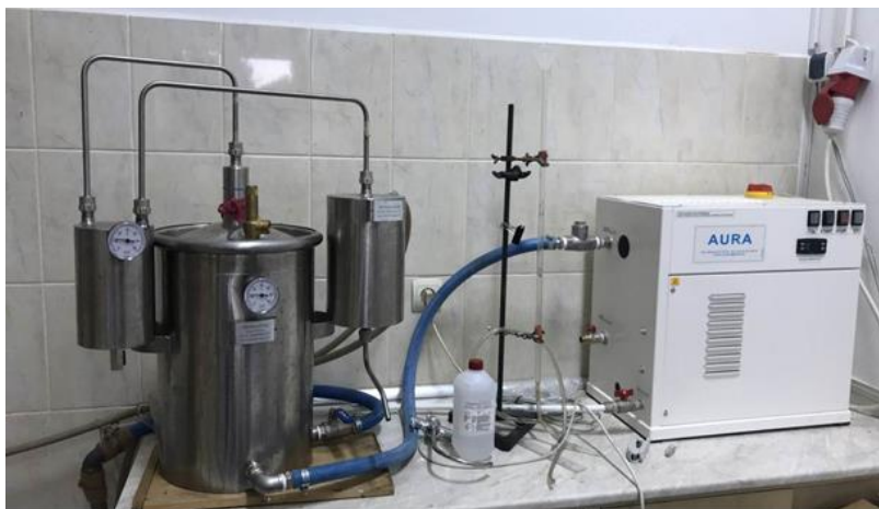
Fig. 5.3 Dispozitivul pentru extracția uleiurilor eterice "Aura"
