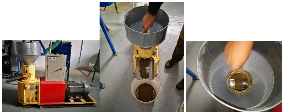
Fig. 9.2. Extruderul folosit pentru granularea furajului medicamentat Fig. 9.2. The extruder used for medicated feed granulation
