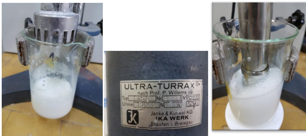
Fig. 10.7. Instalația de preparare a suspensiei de medicament
