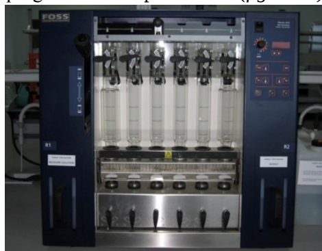
Fig. 5.17. Determinarea proteinelor totale din carne prin metoda Kjeldahl (foto original)
