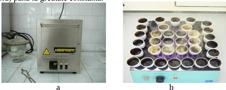
Fig. 5.19. Determinarea conținutului de substanțe minerale din carne prin metoda calcinării (foto original)
