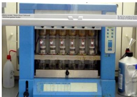
Fig. 5.18. Determinarea grăsimilor totale din carne prin metoda Soxhlet (foto original)
