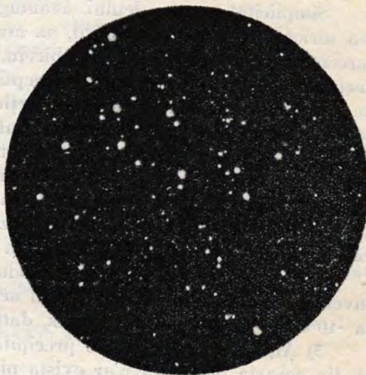
Fig. 3. — Fotografia ultramicroscopică a coloizilor dintr'o zeamă epurată provenind din noul procedeu.
