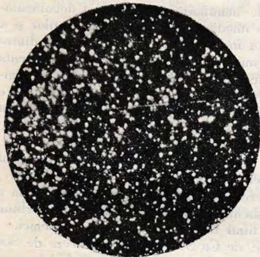
Fig. 2. — Fotografia ultramicroscopică a coloizilor dintr'o zeamă epurată după vechiul procedeu calco-carbonic.
