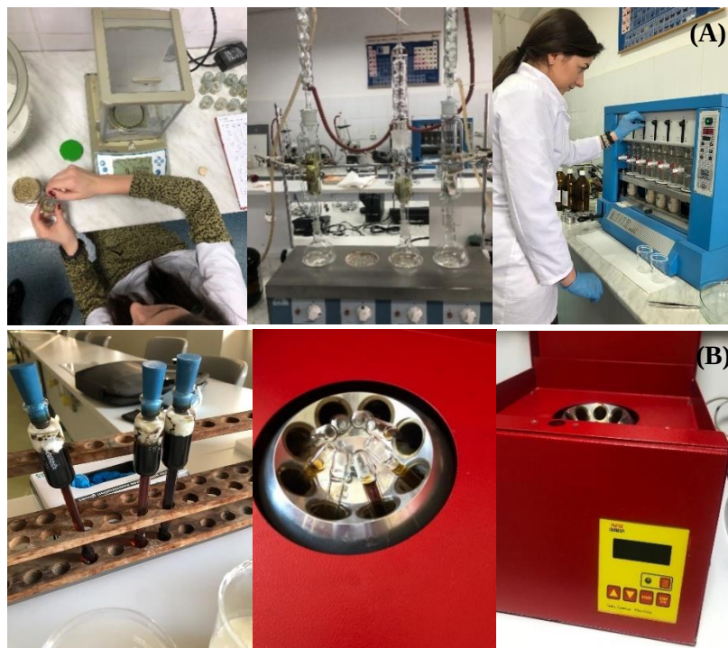
Figura 3.5 Determinarea compoziției chimice brute: grăsimea brută din nutrețuri (A) și lapte (B) Figure 3.5 Determination of crude chemical composition: feed (A) and milk (B) fat composition
