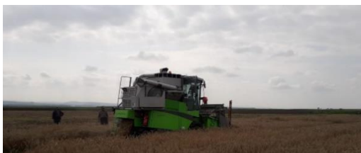
Fig. 3.4 – Combină Wintersteiger pentru câmpuri experimentale (original)
