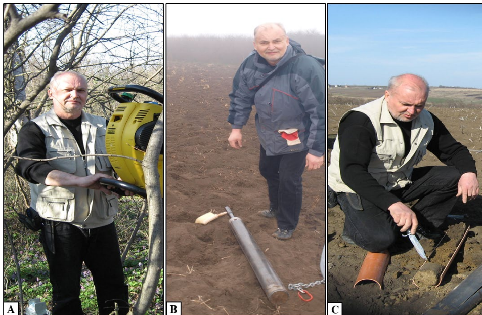
Fig. 3.3 – Extragerea de carote de sol de pe platoul Ezăreni cu folosință silvică (A) și arabil (B – toamna, C - primăvara)
