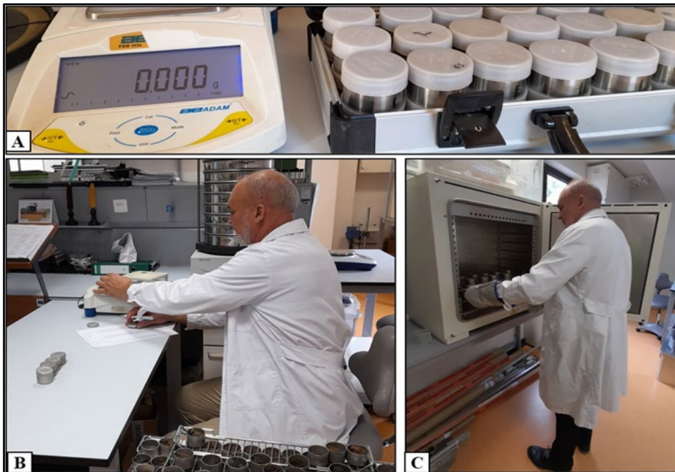
Fig. 3.16 – Pregătirea cilindrilor (A) și fiolelor (B) pentru cântărire și punerea la etuvă (C) Fig. 3.16 - Cylinders (A) and vials preparation (B) for weighing and placing in the oven (C)
