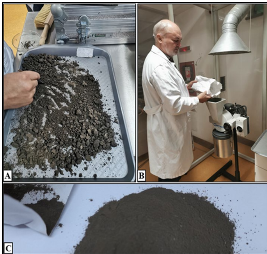
Fig. 3.17 – Pregătirea probelor de sol în aşezare deranjată prin alegerea resturilor vegetale (A), mărunţirea la moara de sol (B) şi solul gata pentru analize (C)
