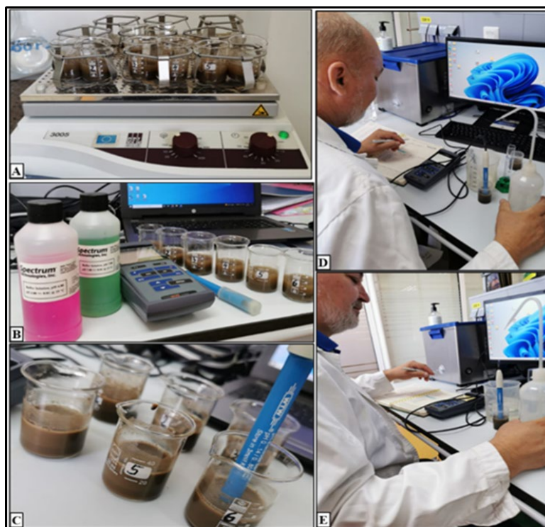
Fig. 3.18 – Pregătirea probelor de sol (A; B și C) pentru determinarea reacției solului (D;E)
