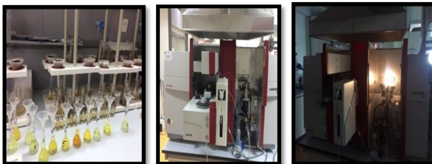
Fig. 3.19. Aspecte privind modul de lucru pentru determinarea \text{Na}^+ din plante, prin metoda fotometriei (original)
