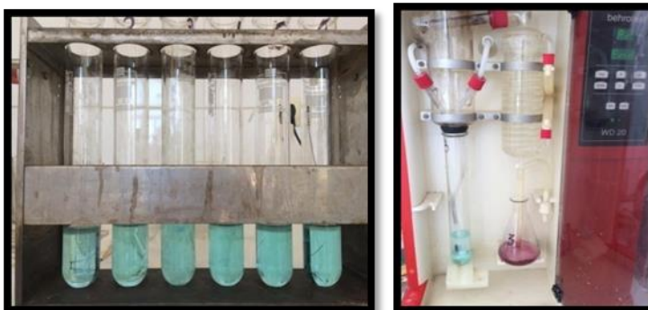
Fig. 3.21. Determinarea proteinei - mineralizarea și distilarea (original)
