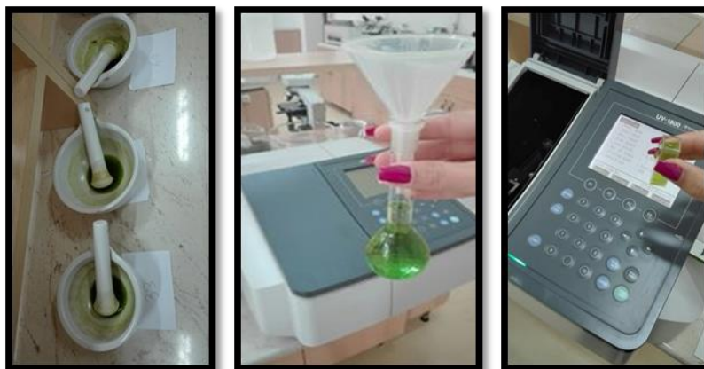
Fig. 3.14. Aspecte privind modul de lucru pentru determinarea conținutului de pigmenți clorofilieni cu spectrofotometrul SHIMANDZU UV-1800 din plante (original)
