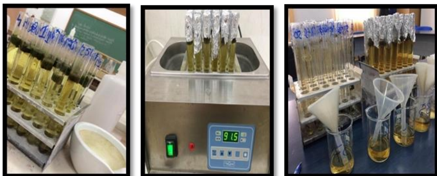
Fig. 3.17. Aspecte privind modul de lucru pentru determinarea conținutului de \text{Cl}^- din frunze (original)
