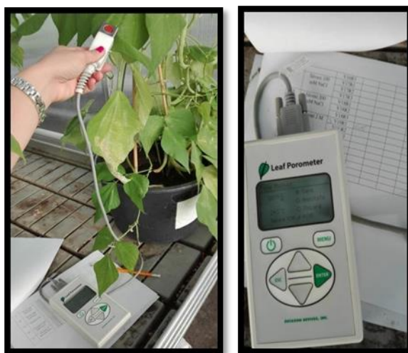
Fig. 3.15. Aspecte privind modul de lucru pentru determinarea conductanței stomatelor cu Porometrul foliar SC-1 la plante (original)
