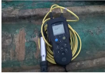
Fig. 4.5 Aparat pentru măsurarea oxigenului solvit și a temperaturii Oxyguard HQ 30D (foto original) Fig. 4.5 Device for measuring of solvit oxygen and temperature Oxyguard HQ 30D (original photo)
