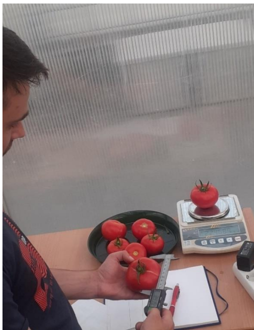
Fig 3.10 Șubler digital și balanță analitică Fig 3.10 Digital caliper and analytical scale (original)
