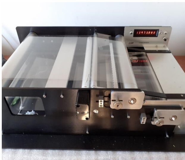
Fig 3.8 Aparat măsurare suprafață foliară Fig 3.8 Foliar surface measuring device (original)
