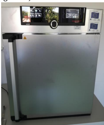
Fig. 5.19. Etuvă Memmert pentru determinarea conținutului de apă din albuș/gălbenuș (foto original)
