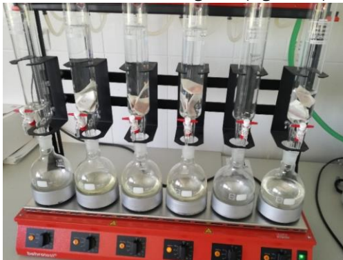
Fig. 5.20. Sistem extracție Velp Scientifica pentru determinarea conținutului de lipide din albuș/gălbenuș (foto original)
