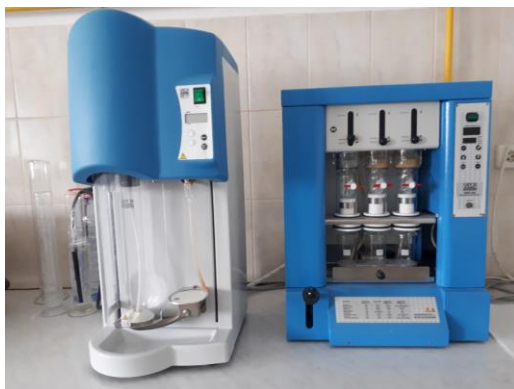
Fig. 5.21. Sistem extracție Velp Scientifica pentru determinarea conținutului de proteine din albuș/gălbenuș (foto original)
