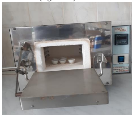
Fig. 5.22. Cuptor de calcinare SuperTherm STC pentru determinarea conținutului de substanțe minerale din albus/gălbenuș (foto original) Fig. 5.22. SuperTherm STC calcination furnace for determination of the content of mineral substances in albumen/yolk (foto original)
