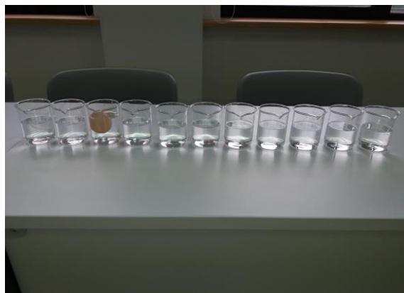
Fig. 5.11. Determinarea greutății specifice la ouăle de bibilică (foto original)
