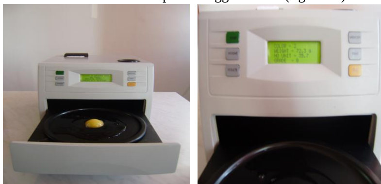
Fig. 5.17. Aparat Egg Analyzer pentru determinarea indicelui Haugh (foto original)
