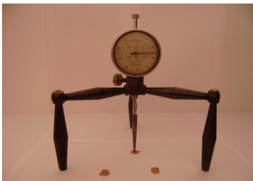
Fig. 5.13. Determinarea grosimii cojii minerale la ouăle de bibilică (foto original)
