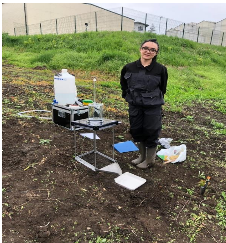
Fig. 4.4. Instalația pentru estimarea eroziunii pe amplasamentul ICAM Iași
