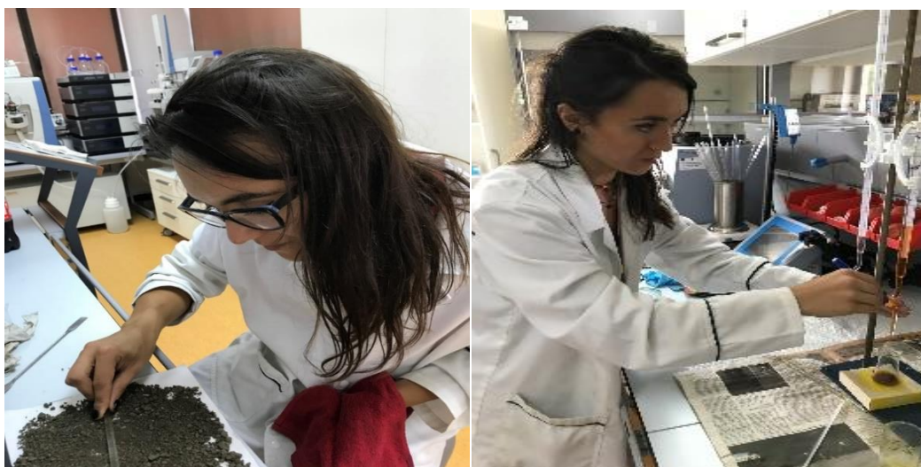
Foto autor.7.6 Eliminarea materiei organice din sol
