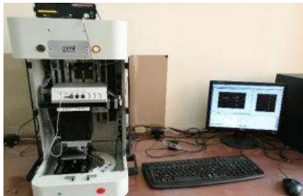
Fig.5.31. Echipament de măsurare a durității Rockwell pentru materialul lamelor-cuțit (poză originală)
