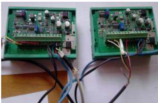
Fig.5.10. Convertoare TA4D/2 (poză originală)
