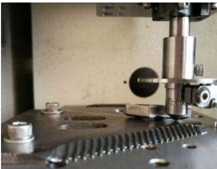
Fig.5.33. Detaliu asupra sistemului de fixare a lamei-cuțit și punctul de aplicare a penetratorului pe suprafața lamei-cuțit (poză originală)
