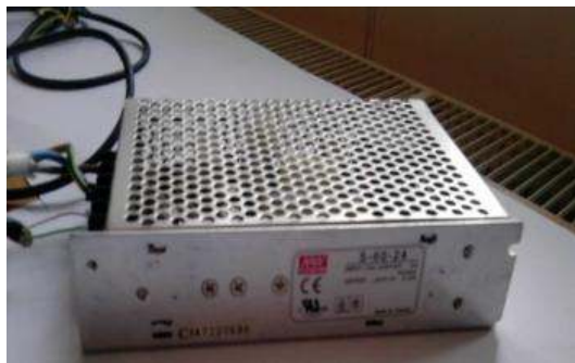
Fig.5.12. Sursa de alimentare S – 60 – 24V (poză originală)
