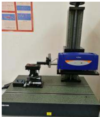
Fig.5.25. Rugozimetru Taylor Hobson utilizat pentru determinarea rugozității lamelor-cuțit (poză originală)
