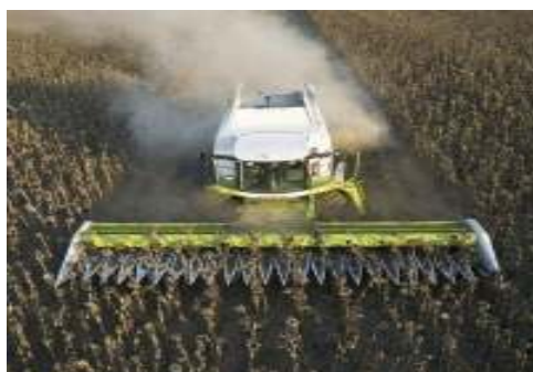
Fig.1.14. Recoltarea cu ajutorul combinei Claas autopropulsată echipată cu heder specializat pentru floarea-soarelui Fig.1.14. Harvesting using a Claas self-propelled harvesting machine equipped with a special header for sunflower http://www.utiben.ro
