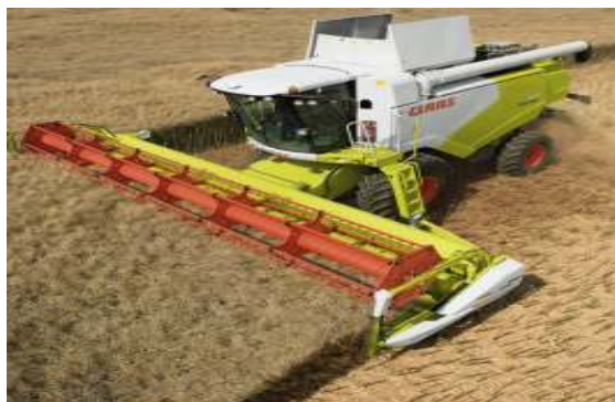
Fig.1.12. Combină Claas echipată cu heder care are despărțitoare de lan prevăzute cu aparate de tăiere, folosite la recoltarea rapiței într-o fază
