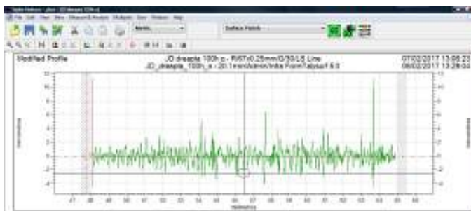
Fig.6.18. Rugozitatea suprafeței unei lame-cuțit de la combina John Deere (poză originală) Fig.6.18. Roughness of a blade-knife surface from John Deere harvesting machine (original photo)
