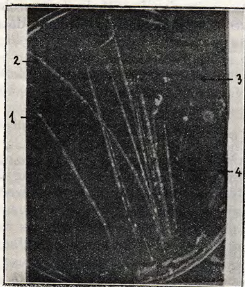
FIG. 2.—Fotografia—reprodusă după Blackett și Occhialini—reprezintă traectoriile electronilor în camera de ionizare. Traectoriile 1 și 2 sunt datorite pozitronilor, iar 3 și 4 electronilor negativi, cari au o deviere mai pronunțată din cauza iuțelii mici. Celelalte traectorii slab deviate într'un sens sau în altul, sunt datorite electronilor cu iuțală f. mare.
