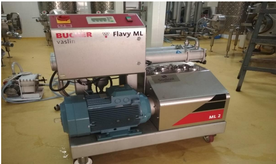
Figura 1.5 Unitate de osmoză inversă (Original)
