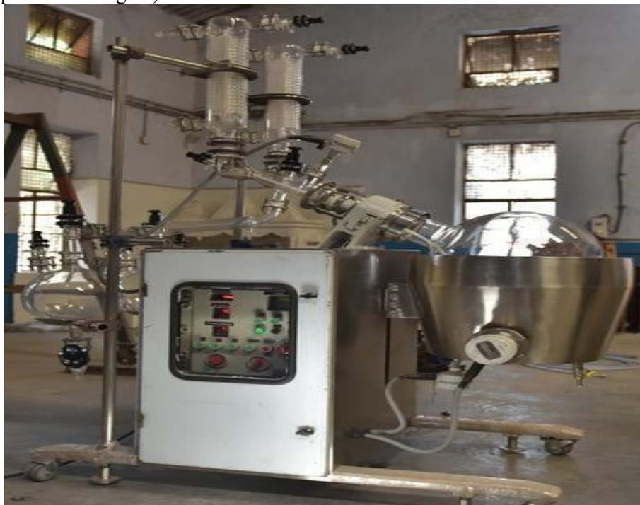
Figura 1.2 Rotaevaporatorul instalație de distilare în vid în mod automatizat Figure 1.2 Rotary evaporator - automated vacuum distillation plant ( ***https://www.newegg.com )
