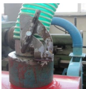
Fig. 4.27. Clapetă pentru reglarea debitului de aspirație
