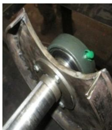
Fig. 4.22. Detaliu constructiv privind prinderea pe ax a discului cu orificiu de alimentare și fixarea lagărului cu rulment pe batiu
