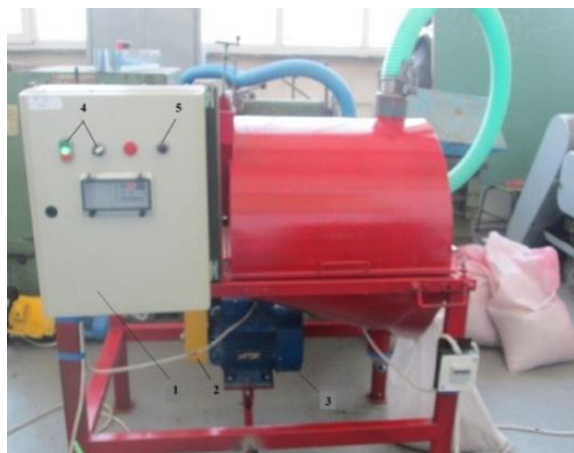
Fig. 4.29. Sistemul de antrenare și reglare a turației rotorului cu perii
