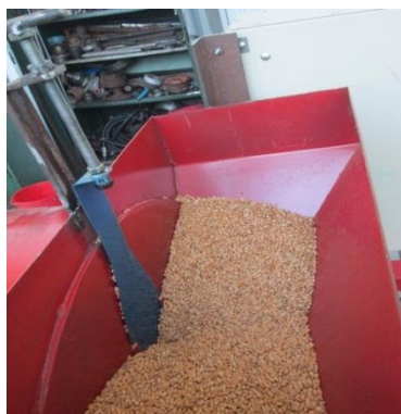
Fig. 4.28. Șuber pentru reglarea debitului de alimentare cu produs
