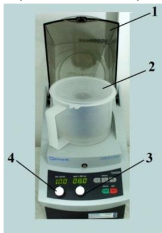
Fig. 4.4. Moară de laborator Grindomix 200, realizată de firma Retsch: 1 – capac; 2 – bol pentru măcinare; 3 – buton pentru reglarea turației; 4 – buton pentru reglarea timpului de măcinare.
