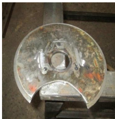
Fig. 4.17. Discul mic al tobei tronconice prevăzut cu orificiu de alimentare
