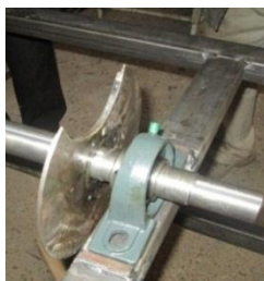
Fig. 4.22. Detaliu constructiv privind prinderea pe ax a discului cu orificiu de alimentare și fixarea lagărului cu rulment pe batiu
