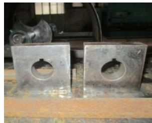
Fig. 4.19. Piese pentru fixarea bridelor pe arbore
