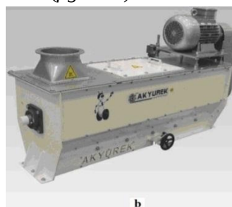
Fig. 2.33. Descojitor de tip AWN realizat de firma Akyürek, Turcia (Akyürek Karderşler, 2013)
