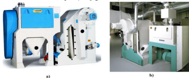
Fig. 2.35. Descojitorare intensive cu aspiratoare pentru recircularea aerului (Akdegirmen, 2013; Bühler Group, 2013): a) realizat de firma Akdegirmen, Turcia; b) realizat de firma Bühler, Elveția
