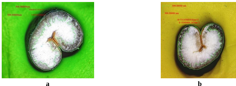
Fig. 6.5. Determinarea suprafețelor umectate din boabele de grâu cu ajutorul softului Aigo Scope 9.0 Fig. 6.5. Determination of wetted surfaces from wheat grains with the Aigo Scope 9.0 software
