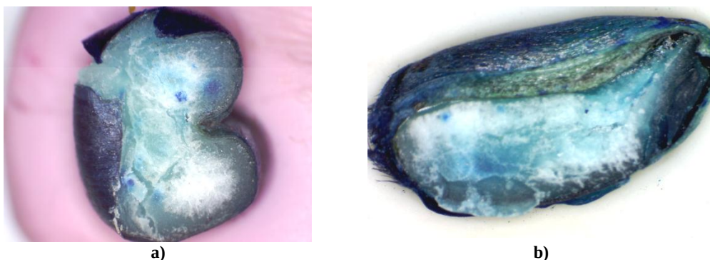
Fig. 6.15 – Boabe de grâu supuse umectării la temperatura din baia de apă de 80°C: a) – în secțiune transversală; b) – în secțiune longitudinală
