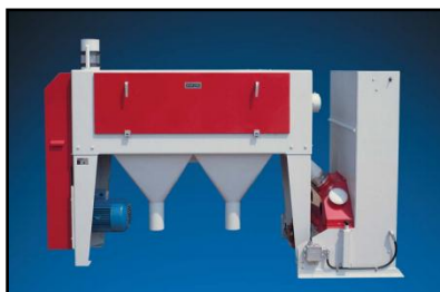
Fig. 2.35. Descojitorare intensive cu aspiratoare pentru recircularea aerului (Akdegirmen, 2013; Bühler Group, 2013): a) realizat de firma Akdegirmen, Turcia; b) realizat de firma Bühler, Elveția
