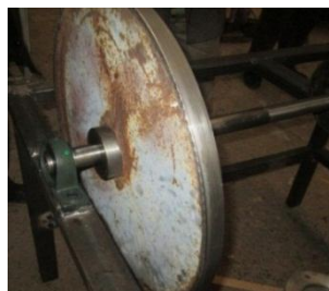
Fig. 4.23. Prinderea pe axa discului cu orificiu de evacuare și fixarea lagărului cu rulment pe batiu
