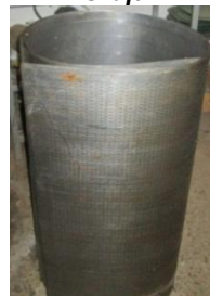
Fig. 4.21. Table perforate utilizate în construcția mantalei tronconice
