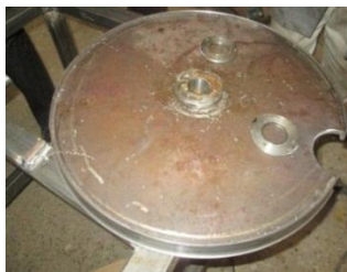
Fig. 4.18. Discul mare al tobei tronconice prevăzut cu orificiu de evacuare
