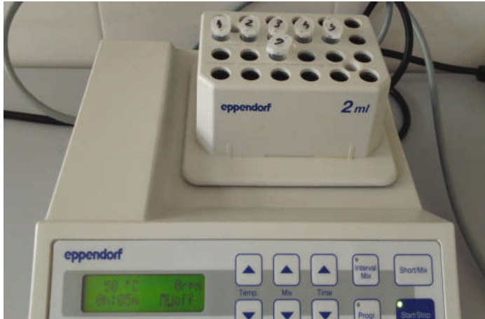
Fig. 7.14. Termomixerul Eppendorf folosit pentru incubarea produșilor PCR Fig. 7.14. Thermomixer Eppendorf used for incubating PCR products
