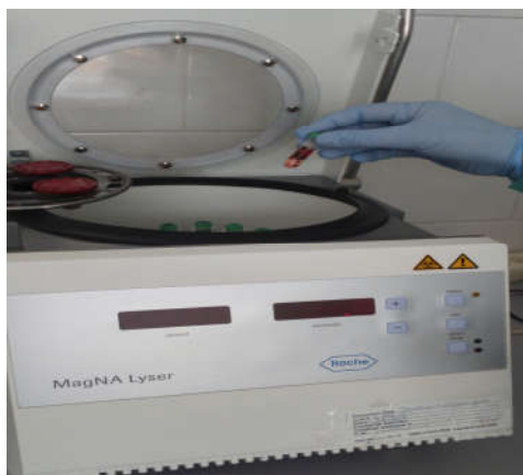
Fig. 7.4. Triturarea probelor de țesut utilizând MagNA Lyser Roche
