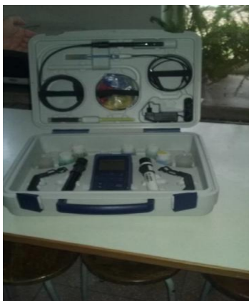
Figura 4.4 pH-metrul WTW 350i/SET folosit pentru determinarea pH-ului și a conductivității electrice (original)
