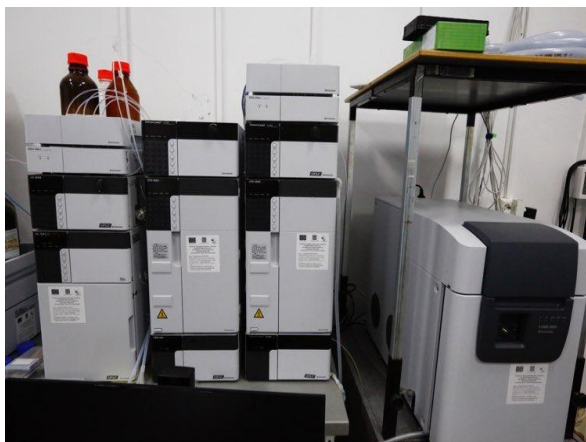
Figura 4.7 Echipament Shimadzu LC-DAD pentru cromatografie lichidă de înaltă performanță (original)
