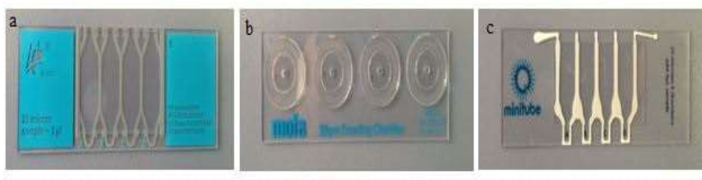
Figura 5.1. Tipurile de camere de analiză utilizate în cadrul studiului pentru examinarea materialului seminal de vier: Leja – 20 \mu\text{m} (a), MofA – 20 \mu\text{m} (b), și Minitube – 20 \mu\text{m} (c)
