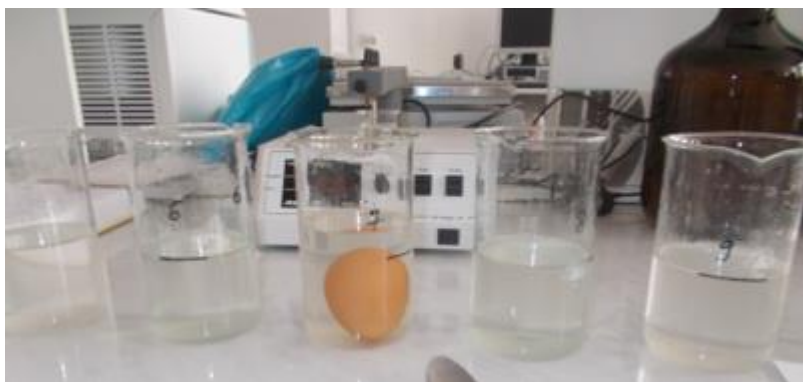
Fig. 4.18. Determinarea greutății specifice a ouălor Fig. 4.18. Determination of egg specific gravity
