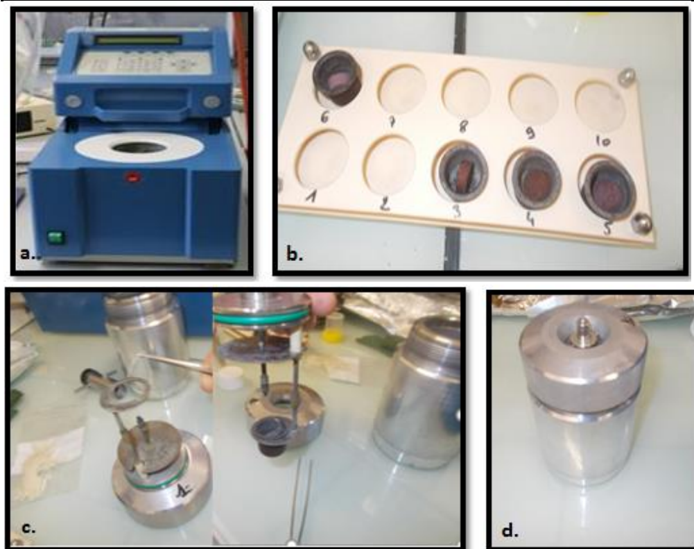
Fig. 4.12. Determinarea energiei brute (a.- Calorimetrul IKA; b.-probe sub forma unor pastile; c,d-bomba calorimetrică)
