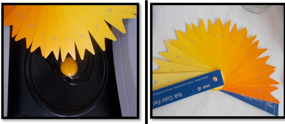
Fig. 4.21. Determinarea intensităţii culorii gălbenuşului la aparatul Egg Analyzer şi compararea acesteia cu evantaiul de culori Hoffman-La Roche
