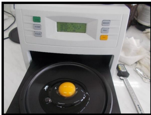
Fig. 4.17. Determinarea greutății oului la aparatul Egg Analyzer Fig. 4.17. Determination of egg weight using the Egg Analyzer device
