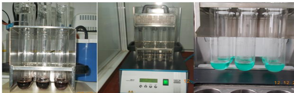
Fig. 4.5. Determinarea proteinei brute: mineralizarea probelor
