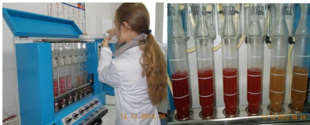
Fig. 4.9. Determinarea celulozei brute: digestia acidă (cu acid sulfuric)
