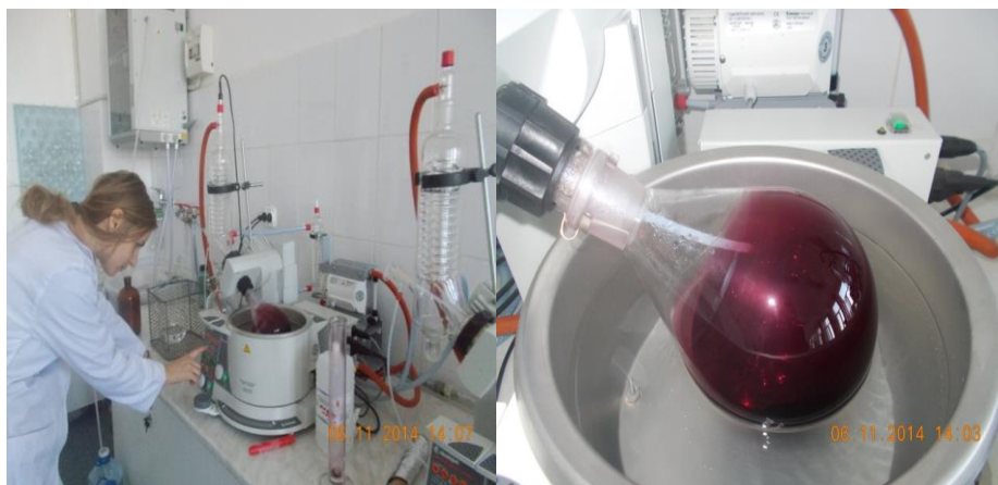
Fig. 5.9. Prepararea extractului apos de polifenoli și recuperarea alcoolului etilic la rotavapor
