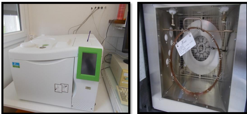
Fig. 4.13. Extracția și determinarea acizilor grași la gaz cromatograf
