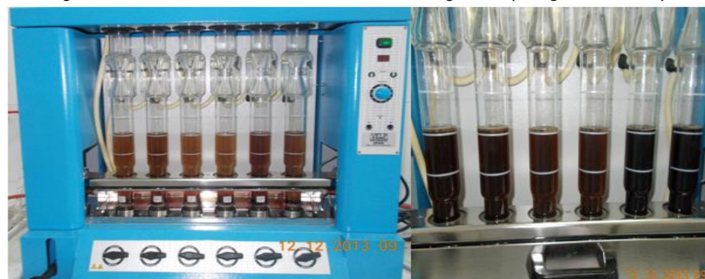
Fig. 4.10. Determinarea celulozei brute: digestia alcalină (cu hidroxid de potasiu)
