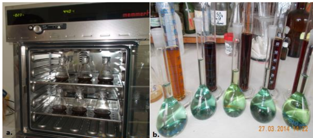
Fig. 4.14. Extracția polifenolilor la termostat (a.) și pregătirea soluțiilor pentru determinarea polifenolilor totali (b.)
