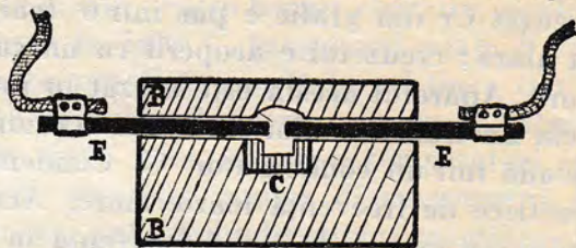
Fig. 2. Cuptorul electric al lui Moissan
