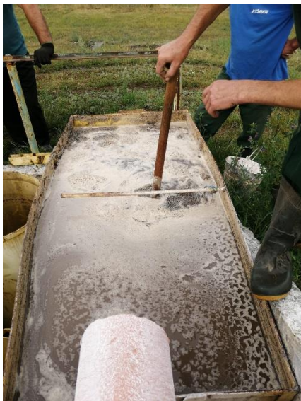
Fig. 5.7 Bazin plin cu apă și sol scurse de pe parcela martor de ogor de 150 mp Fig. 5.7 Basin filled with water and soil drained from the 150 sq m field control plot
