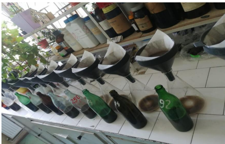
Fig. 5.9 Prelucrarea probelor în laborator prelevate de la parcelele standard pentru controlul scurgerilor
