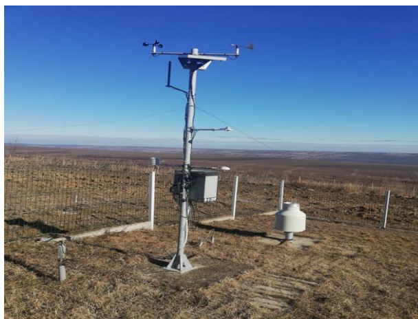
Figura 5.5 Stația meteo automată-model AddVantage Pro 6.5 de la SCDCES Perieni
