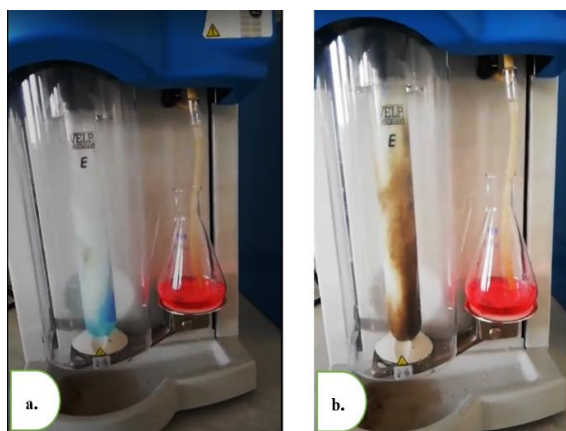
Figura 5.12 Distilarea probelor de carne în vederea stabilirii conținutului proteic/ Distillation of meat samples to establish the protein content
