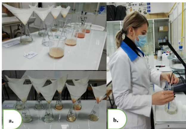
Figura 5.10 Determinarea valorii pH a cărni/ Determination of pH value a-pregătirea probelor/ sample preparation ; b-determinarea acidității cu pH-metrul WTW inoLab 7110/ determination the acidity with pH meter WTW inoLab 7110 (foto original)
