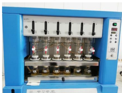
Figura 5.13 Determinarea conținutului în lipide – etapa a doua, spălarea/ Determination of the lipid content-second phase, washing (foto original)
