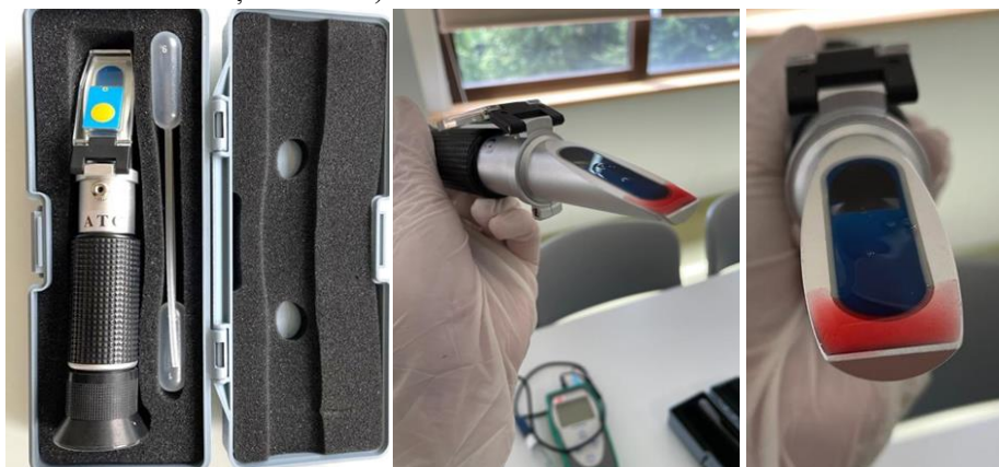
Fig. 4.13. Aspecte din timpul determinării substanței uscate solubile prin metoda refractometrică (original)
