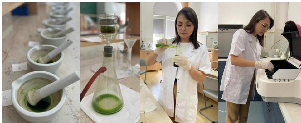
Fig. 4.7. Aspecte din timpul determinării conținutului de pigmenți prin metoda spectrofotometrică (original)
