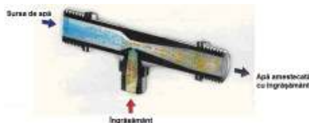
Fig.2.43. Dozator de îngrășămint Venturi Alfa
