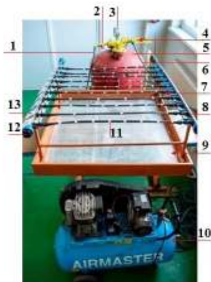
Fig.4.22. Standul experimental (poză originală): 1 – furtun de alimentare cu apă și filtru; 2, 4 – robinet; 3 – manometru; 5 – rezervor apă; 6 – cablu compresor; 7 – bandă de udare; 8 – conducta principală; 9 – schelet metalic cu platformă; 10 – compresor; 11 – picurător; 12 – dopuri de închidere a conductei principale; 13 – I ... X – numerotarea liniilor de udare.
