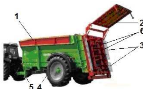
Fig.2.7. Mașină de împrăștiat îngrășăminte organice solide Unia Apollo: 1 – benă de oțel; 2 – apărătoare; 3 – capac adaptor; 4 – tren de rulare; 5 – bară de tracțiune; 6 – tobe de împrăștiere verticale.
