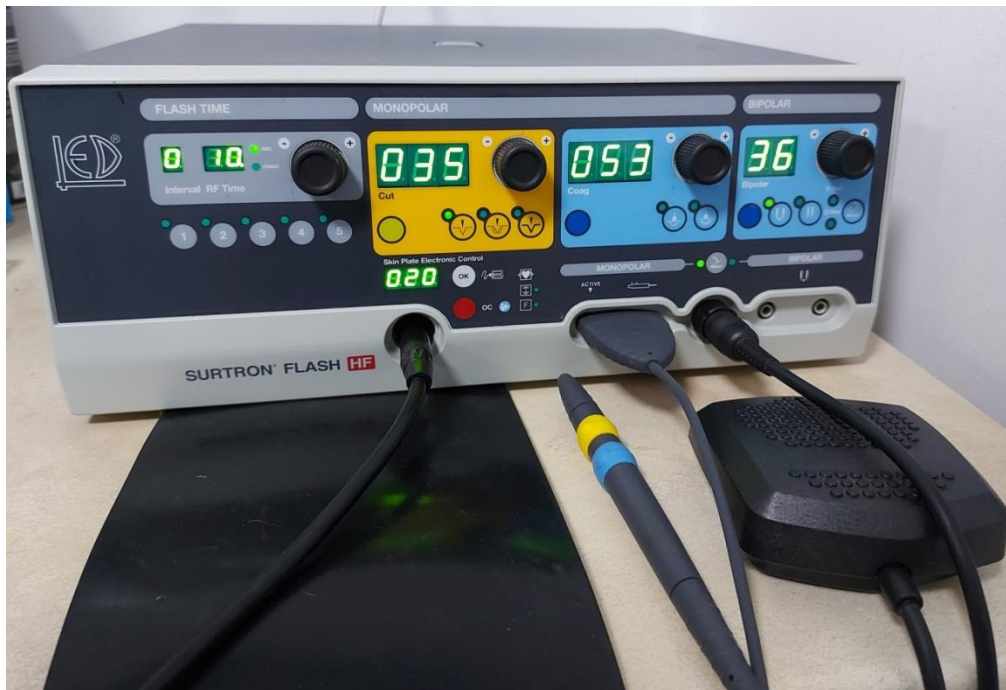
Fig.. 5.4. Montarea aparatului LED Surtron Flash HF 160 pentru chirurgia în mod monopolar (original)
