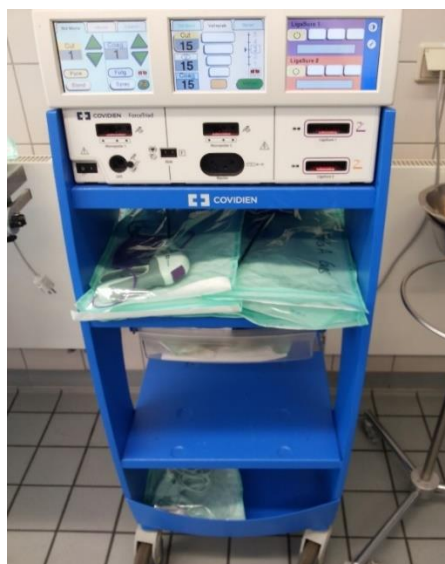
Figura 9.3. Generator de curent cu frecvența de 500 Hz COVIDIEN Force Triad (ForceTriad™ , Covidien, Germania) (original)
