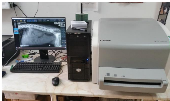
Fig. 5.2. Aparatul Smart X-CR și soft-ul de vizualizare a imaginilor radiologice, Examion AQS (original)
