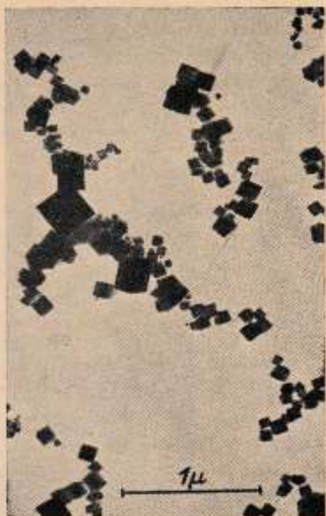
Fig. 2. Cristali de oxyd de magneziu la microscopul electronic. Sînt cubi proveniți din arderea magnesiului. De observat gruparea cubilor în lanțuri. Mărire: 27.000 ori.
