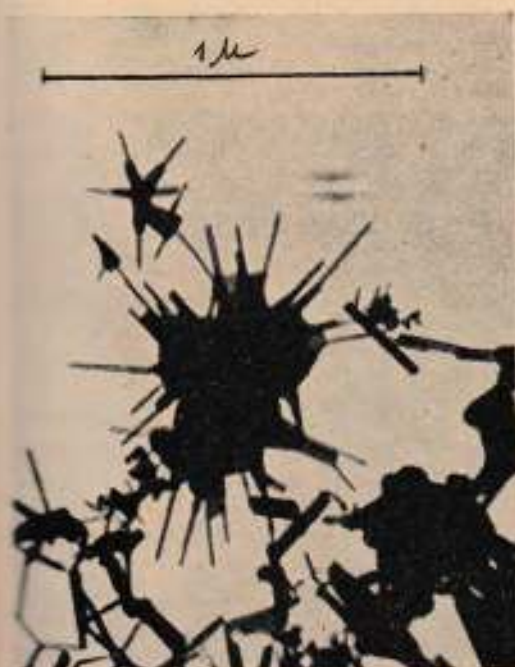
Fig. 1. Structura fumului de oxyd de zinc, la microscopul electronic. Se constată ace lungi, uneori despicate în două, și pornind din centrul de cristalizare (după v. Ardenne). Mărire: 34 000 ori.
