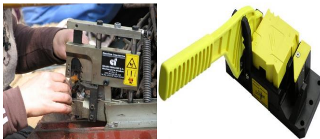
Fig. 2.4 Mașină semiautomată de altoit și ghilotină pentru altoire în copulație
