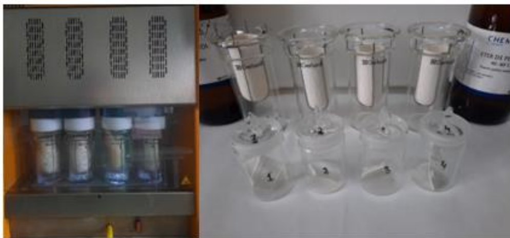
Figura 5.16. Sistem Soxhlet pentru extracția grăsimii și materialele necesare (foto original)
