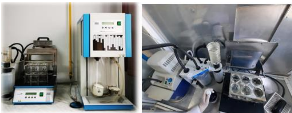
Figura 5.14. Sistem Kjeldahl – Velp (determinarea proteinei brute) (foto original)
