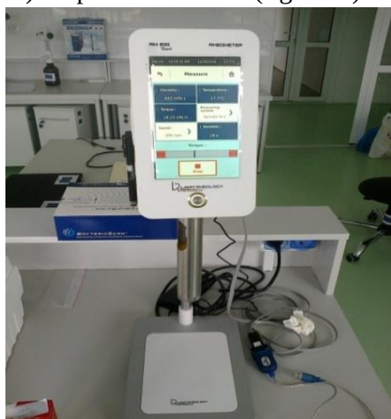
Figura 6.14 Determinarea vâscozității cu reometrul Lamy Rheology (original)
