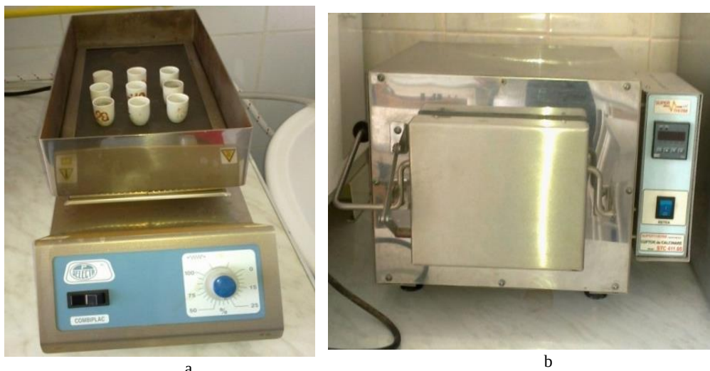
Figura 6.18 Determinarea conținutului în substanțe minerale totale (original) a-carbonizarea probelor; b-calcinarea probelor; Figure 6.18 Determination of total mineral content a-samples carbonization; b-samples calcination;
