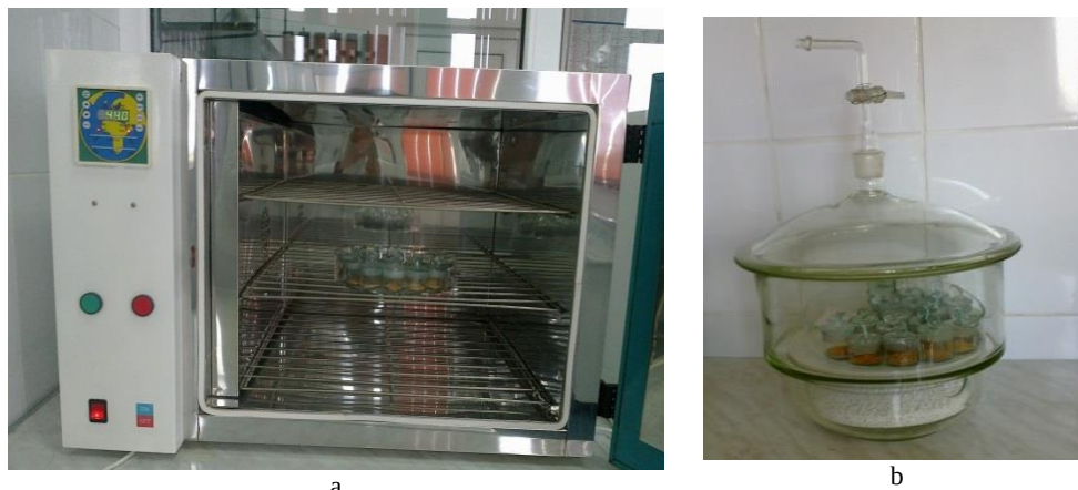
Figura 6.15 Determinarea conținutului în substanță uscată prin uscarea la etuvă(original) a-etuvă termoreglabilă; b- exicator
