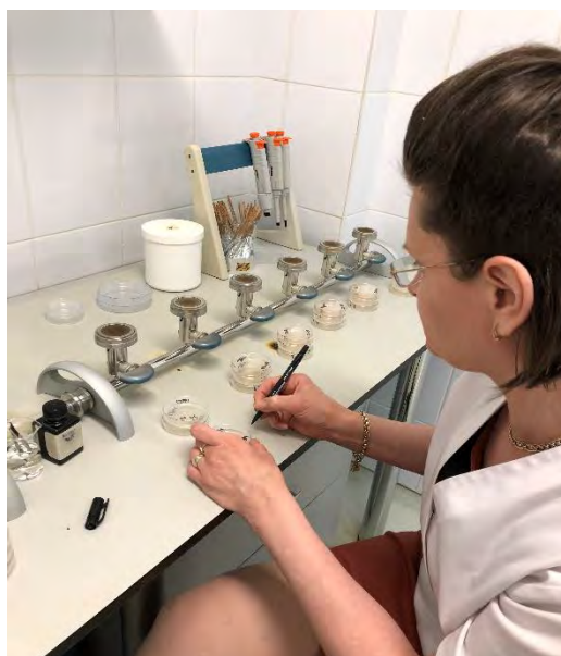
Fig.8.5. Pregătirea plăcilor pentru însămânțarea prin metoda filtrării cu membrană
