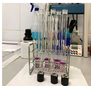
Fig. 8.4 Confirmarea E. coli prin testul indolului
