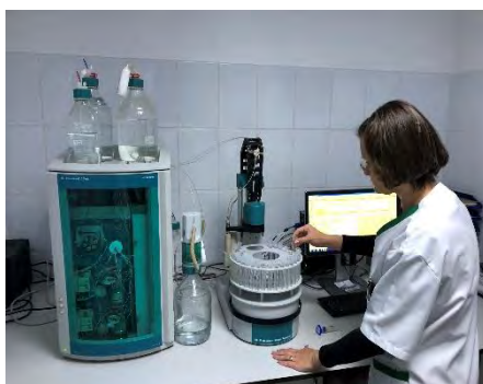
Fig. 7.5. Ion cromatograf Metrohm Fig. 7.5 Metrohm Ion chromatograph
