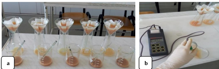
Figura 5.13 Determinarea valorii pH (original) (a - pregătirea probelor; b - determinarea valorii pH cu ajutorul pH-metrului)
