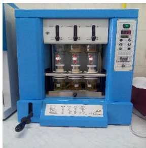
Figura 5.18 Determinarea conținutului în grăsime - faza de spălare (original)
