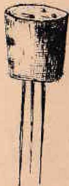
Fig. 21. Dop de plută cu ace pentru perforat pielea fructelor.
