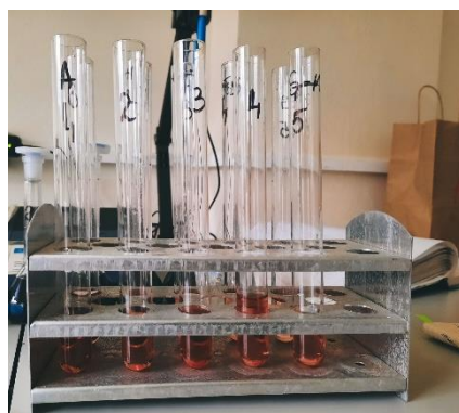
Figura 7.2 Reacția leucoantocianilor cu alcoolul etilic 95% și HCl concentrat (original)/ Figure 7.2 Reaction of leucoanthocyanins with 95% ethyl alcohol and concentrated HCl
